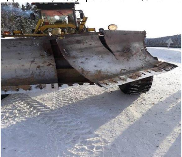
При следовании поезда со скоростью 70 км/ч машинист увидел транспортное средство, выезжающее с левой стороны на переезд, в непосредственной близости от поезда и применил экстренное торможение, но из-за малого расстояния предотвратить столкновение не удалось. В габарите оказался передний ковш автогрейдера. Удар ковша по касательной вправо по ходу движения сторону локомотива.
